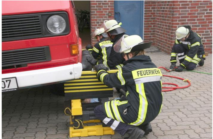
**Ein Feuerwehrfahrzeug wird von den Kameraden zu Übungszwecken angehoben und gesichert.**
