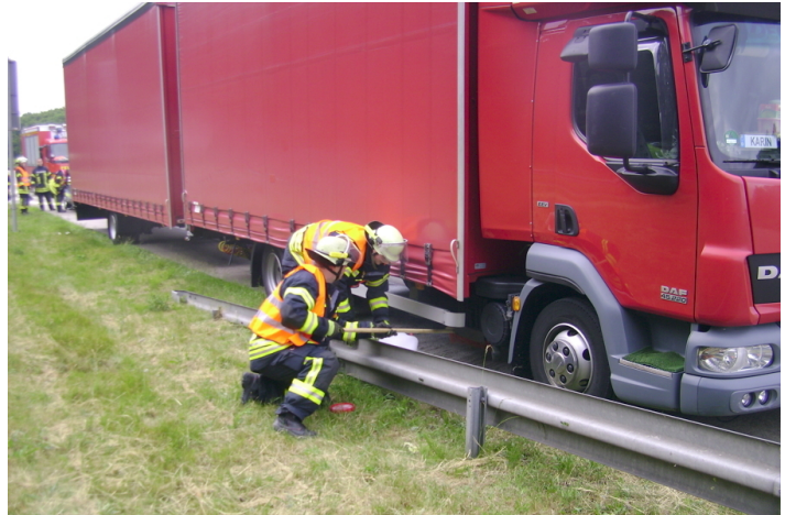
Die Einsatzkräfte der Feuerwehr arbeiten daran, das Leck am Tank abzudichten.
